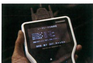
カメラ・レーダー・センサーなどを調整・校正・点検するためにスキャンツール（診断機）で数値を確認します。
